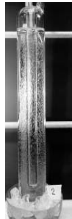
Celda del punto triple del agua, estas celdas se construyen y mantienen en el laboratorio de termometría del CENAM y definen al kelvin.
