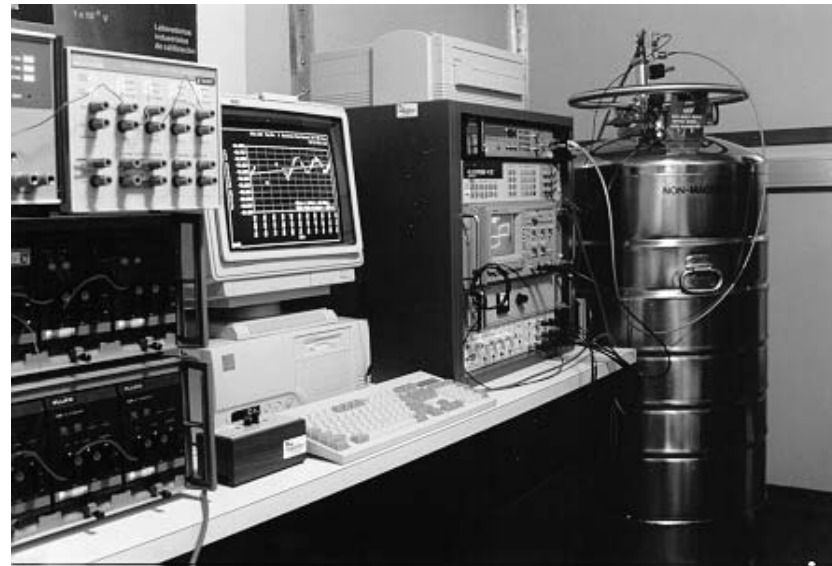
Laboratorio de patrón de tensión del CENAM, donde se mantiene en operación el efecto Josephson.
